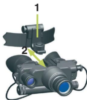
Механизм оголовья предусматривает также возможность откидывания наверх очков без снятия оголовья. Для этого нажмите (5) и поднимите очки вращением (6).
